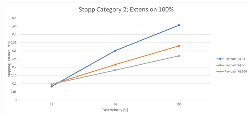
Fig. .1744 : Distanza; Arresto cat. 2; Giunto 4 100%.
