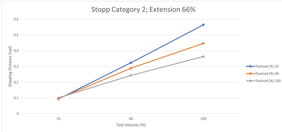
Fig. .1726 : Distanza; arresto cat. 2; giunto 1 66%.
