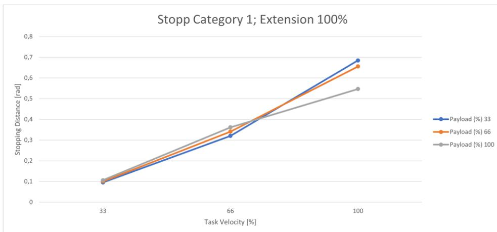
Fig. .1718 : Distanza; Arresto Cat 1; Giunto 3 100%
