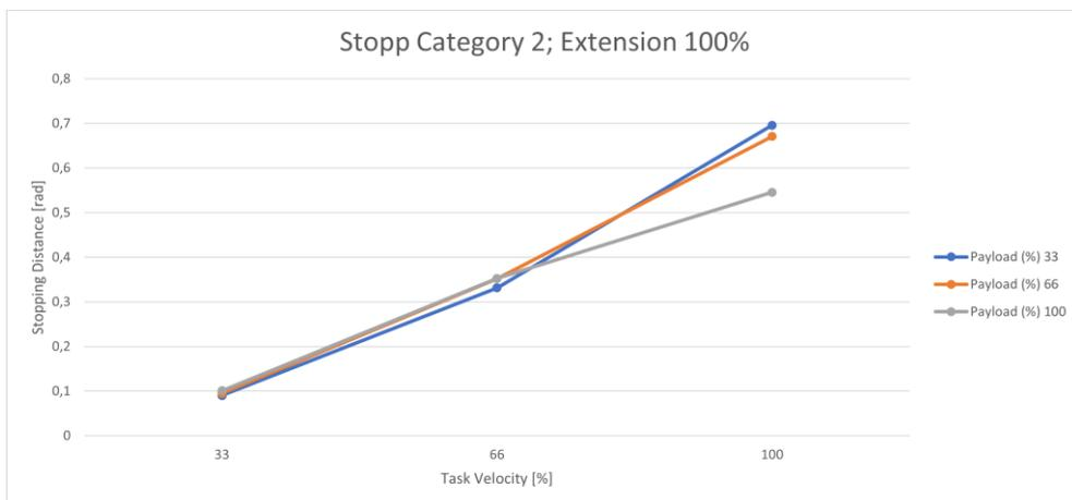
Fig. .1740 : Distanza; Arresto Cat 2; Giunto 3 100%
