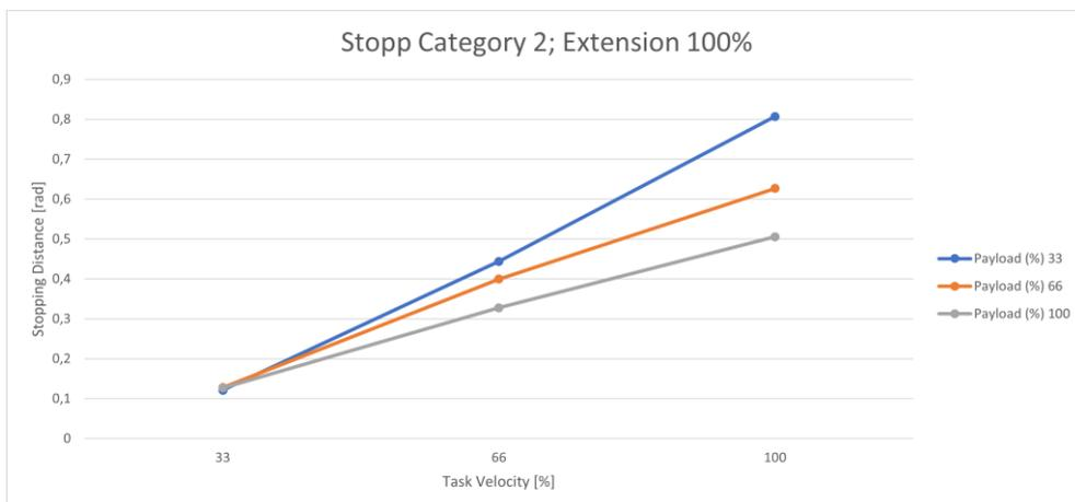
Fig. .1728 : Distanza; arresto cat. 2; giunto 1 100%.
