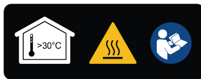
Obr. .33 : Štítek horkých povrchů
