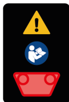
Obr. .32 : Štítek nouzového odblokování
