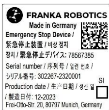
Obr. .38 : Typový štítek zařízení pro nouzové zastavení
