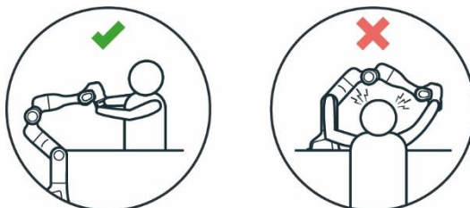
Obr. .1029 : Vzdálenost k rameni narážejícímu do hlavy
