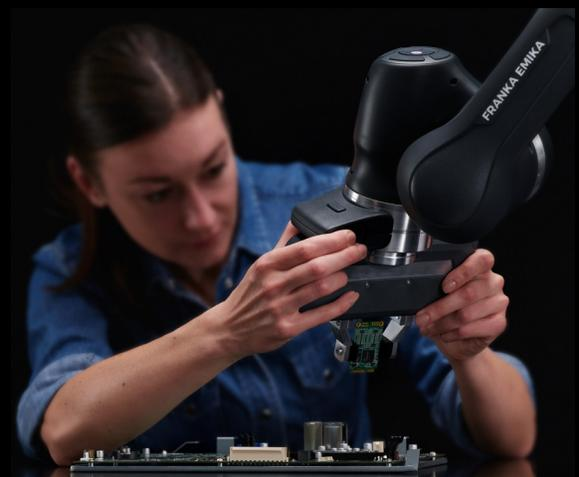
C. Lernen Sie den Roboter durch manuelle Führung ein und parametrisieren Sie jede App über dialogbasierte Interaktion.
