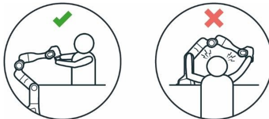
图59：机械臂与头部碰撞距离示意图
