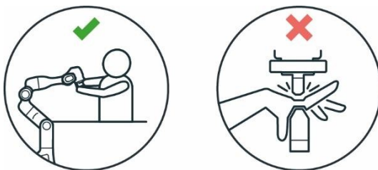
Figur 7.30: Afstand til arm, der klemmer hånden
