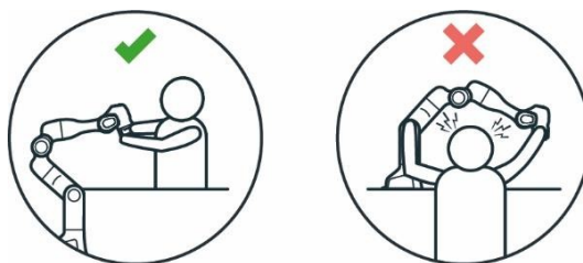
Figur 7.28: Afstand til arm, der støder mod hovedet
