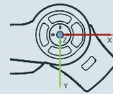
Ausrichtung Achse 7 ohne Endeffektor
